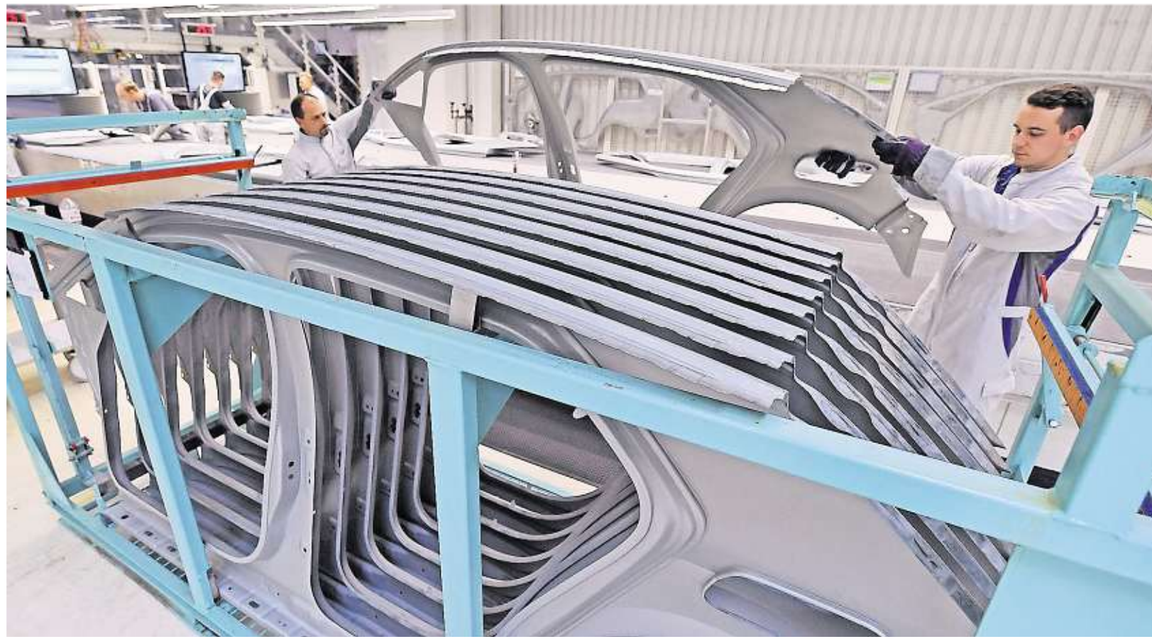
Seitenteile für das neue Elektroauto ID.3 werden im sächsischen Presswerk von Volkswagen in Zwickau produziert.
